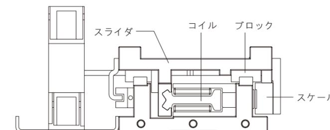
測定した結果により、たとえ同じ熱エネルギーを消費しても、移動速度が速いモーター可動子は、同じ設計仕組みにより高い熱対流を持ちますので、熱平衡温度が低いです。
