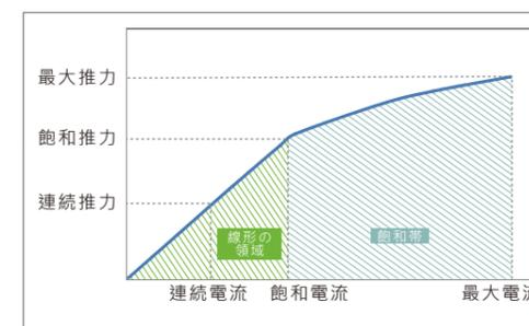
リニアモーター線形の領域で、推力は電流と正比例関係で、推力定数は一定の値です。飽和領域を入力するときは推力が磁気飽和現象になり、推力と電流の非線形な関係をもたらす上昇推力の速度を低下させます。
